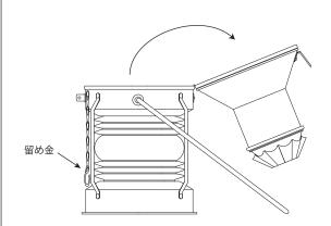
2.ソケットからランプを左回しで外し、交換します。
