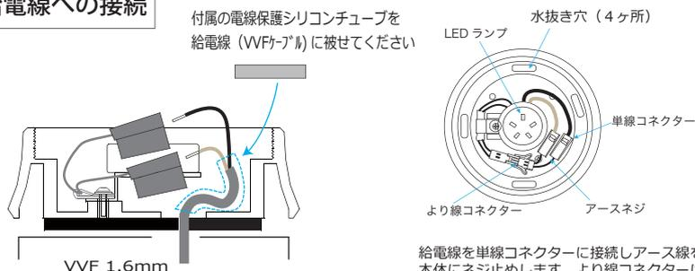
引き込んだ VVF ケーブルから 10mm 銅線を剥いて図のようにコネクターへ差し込んで下さい。
