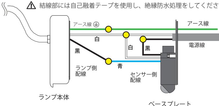
※アース線を接続してD種接地工事をしてください。
