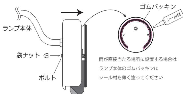
袋ナットはしっかりと締め、ランプ本体をベースプレートに確実に固定してください。
