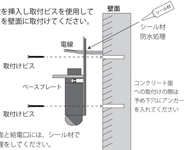
※取付け面と給電口には、シール材で防水処理をしてください。(凹凸のある面は平滑になるようする)
