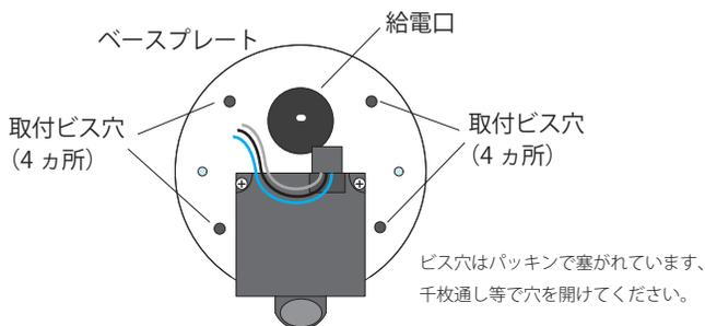
袋ナットを外し、ベースプレートをランプ本体から取り外します。取付ける場所にベースプレートをあてて、位置を確認し、ビス穴の位置など、壁面に印をつけてください。
