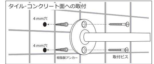
取付位置を決めて壁面の取付ビスの位置にドリルで直径4mmの穴を開けます。付属の樹脂製アンカーを挿入し、取付ビスでタオルパー本体を取付けます。
