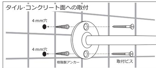
取付位置を決めて壁面の取付ビスの位置にドリルで直径4mmの穴を開けます。付属の樹脂製アンカーを挿入し、取付ビスでタオルパー本体を取付けます。
